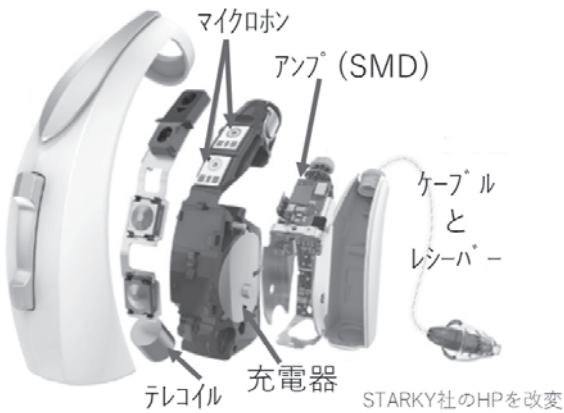
図3. 補聴器の内部構造
